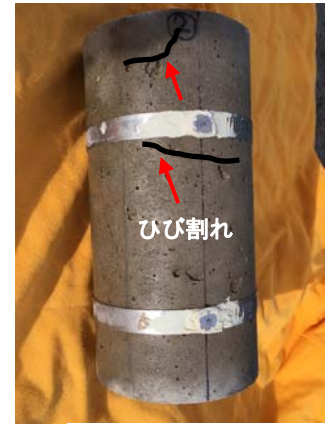
写真-3 供試体の外観状況 (試験日数 224 日)
