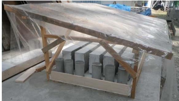
写真一 吸い上げ実験設置状況
