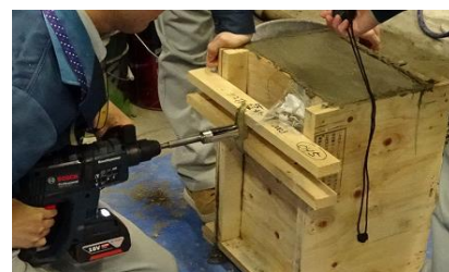
写真-3 電動ハンマによる加振状況
