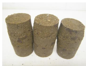
写真－２ 破壊性状（配合 S30-50 供試体）
