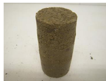
写真－３ 破壊性状（配合 S30-100 供試体）
