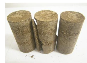
写真－４ 破壊性状（配合 S30-200 供試体）
