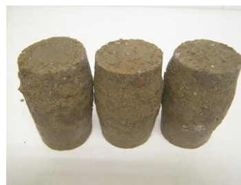
写真－１ 破壊性状（配合 S30-25 供試体）
