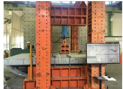
(b) 押抜きせん断試験
