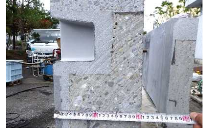
写真-12 試験体切断面 (ステップ背面付近)
