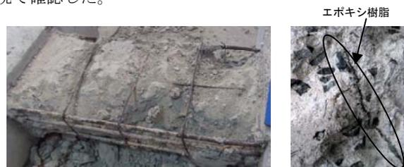
図-8 配筋状況およびエポキシ樹脂浸透状況
