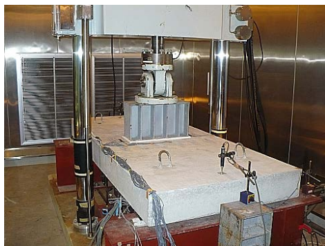
写真-1 定点疲労試験状況
