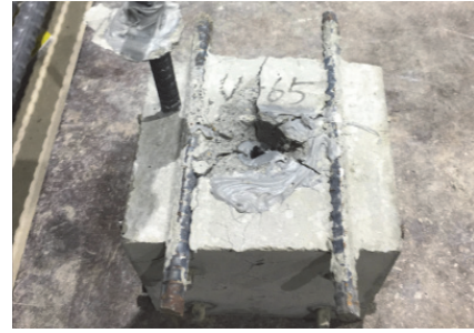
写真-1 供試体 U65-No. 2 の破壊状況
