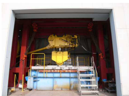
写真－1 輪荷重走行試験機 (IHI インフラシステム)
