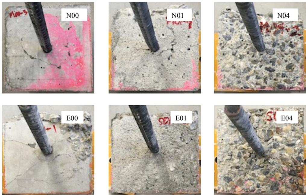
図一九 打継部の浸水の様子
