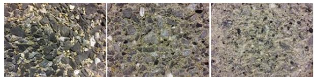
写真-2 はつり面(左 : WJ, 中 : SB, 右 : CH)
