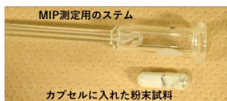
写真-1 粉末試料と測定用ステム
