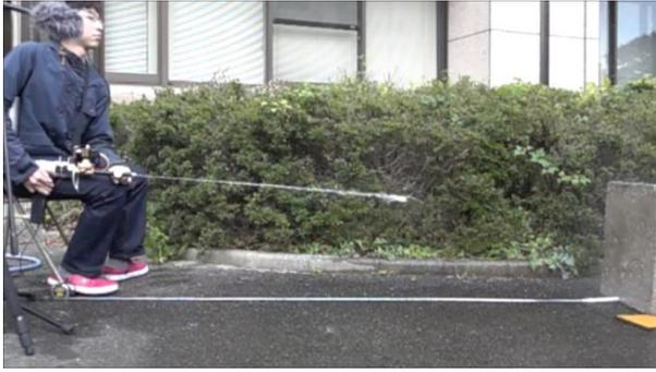
図-7 パルス水撃音響法試験
