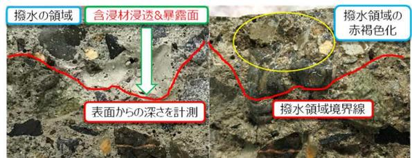
a) 水による撥水状況 b) 硝酸銀水溶液噴霧状況
