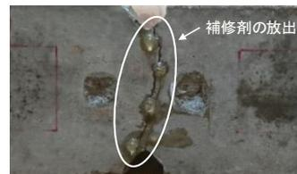
図-6 補修剤 EP の外部放出の一例
