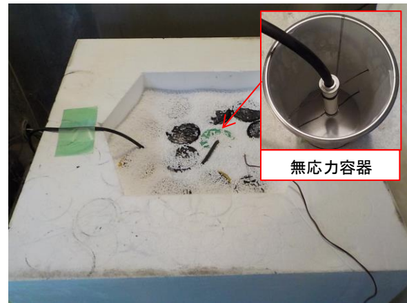
写真-1 簡易断熱養生箱と無応力容器
