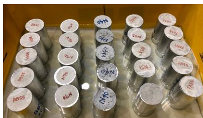
図-1 液状水浸せき試験の試験風景と概略図
