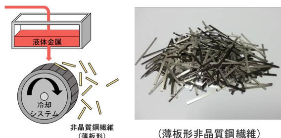
図-1 薄板形非晶質鋼繊維の作製方法
