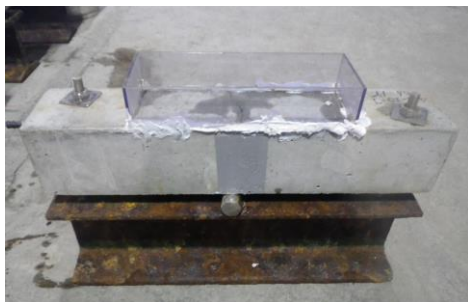
図-2 持続荷重供試体
