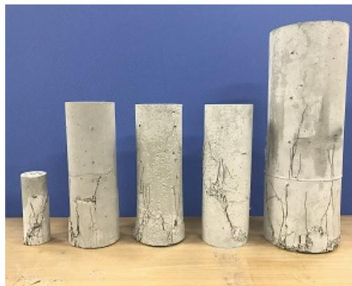
写真-2 試験体破壊状況の一例
