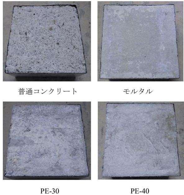
図 - 12 60 サイクル終了後試験面の例
