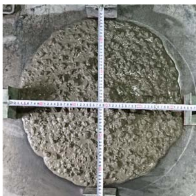
写真-1 スランプフローの様子(PCE-V)
