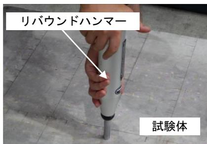
写真-2 リバウンドハンマーによる測定状況
