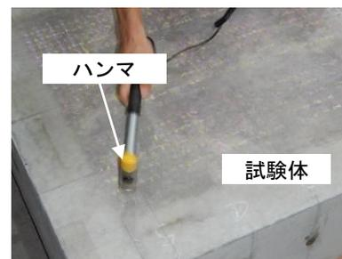
写真-4 機械インピーダンスの測定状況
