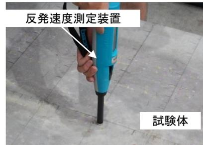
写真-3 反発速度測定装置による測定状況
