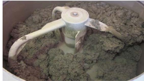
写真-1 断面修復材の練混ぜ状況
