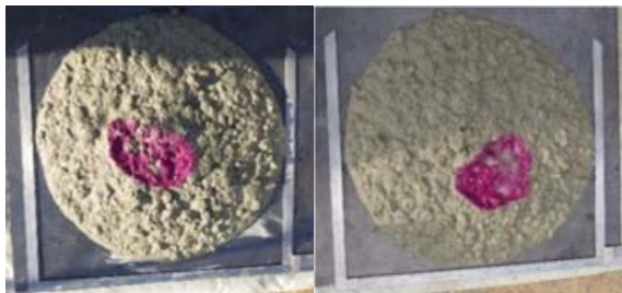
写真-3 荷卸し時に採取したコンクリートのT-ポストスランプ試験におけるスランプフロー47cm時点の状況 （左：スランプ8cm，右：スランプ12cm）
