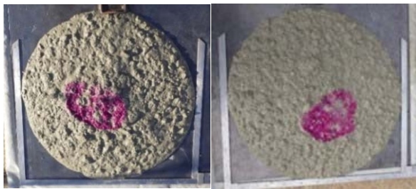
写真-4 荷卸し時に採取したコンクリートのT-ポストスランプ試験におけるスランプフロー52cm時点の状況 （左：スランプ8cm，右：スランプ12cm）
