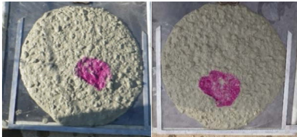
写真-5 筒先採取コンクリートのT-ポストスランプ試験におけるスランプフロー52cm時点の状況 （左：スランプ8cm，右：スランプ12cm）
