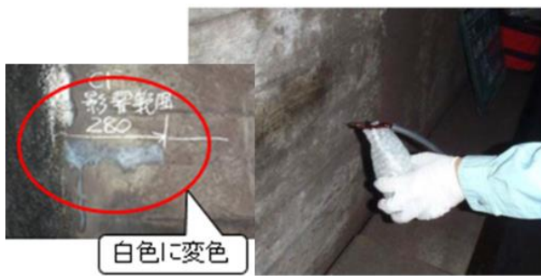
写真-1 硝酸銀溶液の噴霧状況
