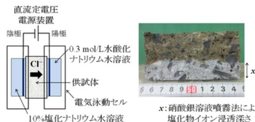
(A)試験方法の模式図 (B)塩化物イオン浸透深さの測定例
