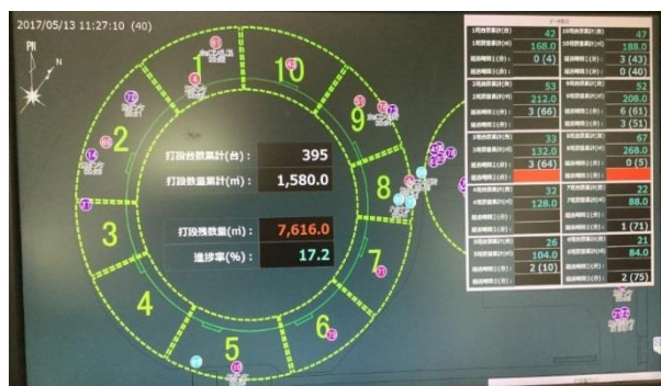
写真-1 アジテータ車運行管理システム操作画面
