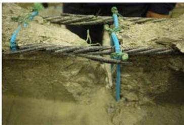
写真-1 圧壊時の PC 桁上縁部の状況
