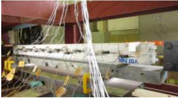
図-3 一軸引張強度試験状況
