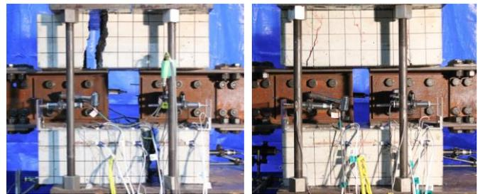
写真-1 載荷実験後の試験体
