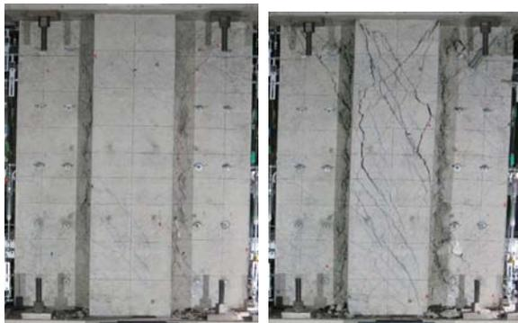
(a) 正側最大耐力時 (b) 正側最大変形時
