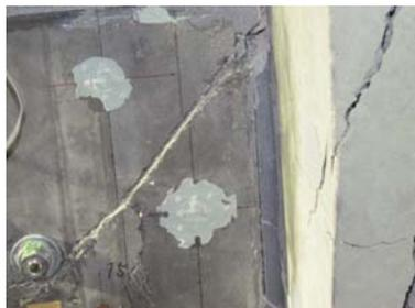
写真-4 UFCパネルのせん断ひび割れ (CW3-SR2)
