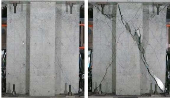
(a) 正側最大耐力時 (b) 正側最大変形時
