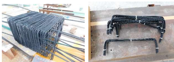
写真-1 CFRP より線で製作した補強材
