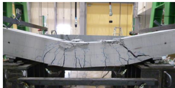
写真－2 試験体 1-1 破壊状況
