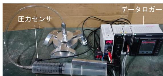
写真-3 圧力計測の様子
