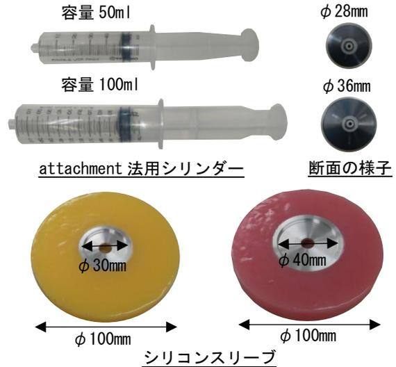
写真-2 attachment 法用シリンダー形状、シリコンスリーブおよび測定の様子
