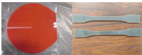
写真－1 (a) 接着剤板と(b)引張試験片の例
