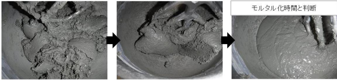
図-4 モルタル化時間の判断の目安
