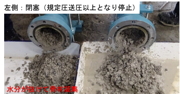
写真－2 ポンプ圧送性室内試験装置の閉塞状況
