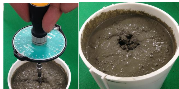
写真-1 ベーンせん断試験機の外観と測定後の供試体
