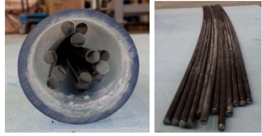
写真-3 気化性防錆剤付着の様子（圧入 3g）
