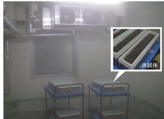
写真一1 凍結融解試験の様子
