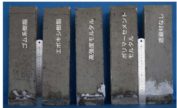
写真一四 遮蔽材を設けた条件の比較
