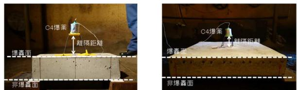
(a) 鉄筋コンクリート梁 (b) 鉄筋コンクリート版
