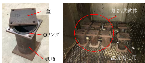
図-2 シール（鉄瓶）養生および加熱炉内の設置状況
