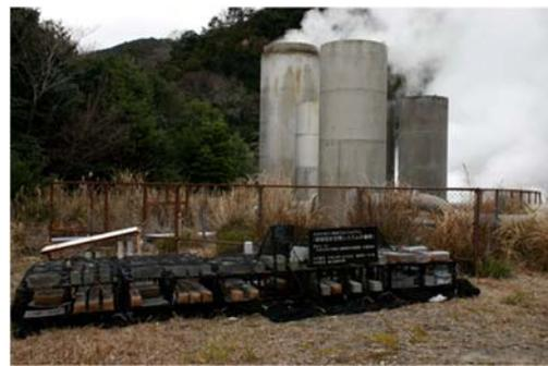
写真-13 霧島火山帯における暴露実験 (奥の土壌中にも埋設)
