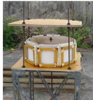
写真-11 8方位ドライガーゼ捕集器
