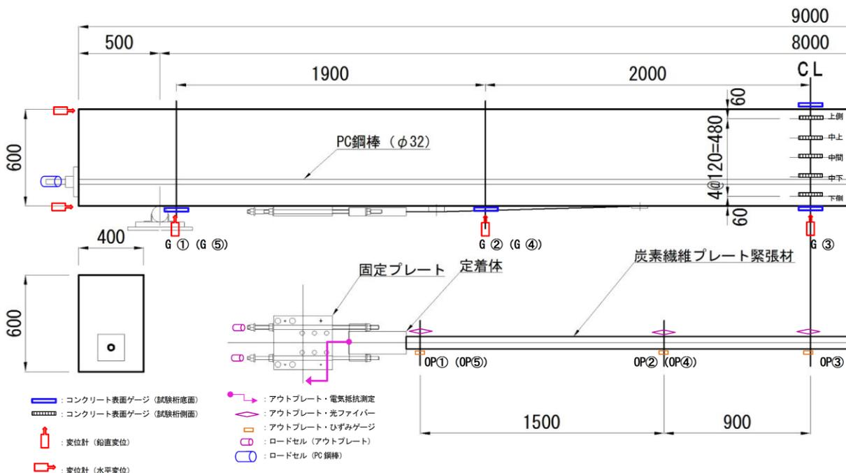
図-4 はり供試体寸法と測定位置
