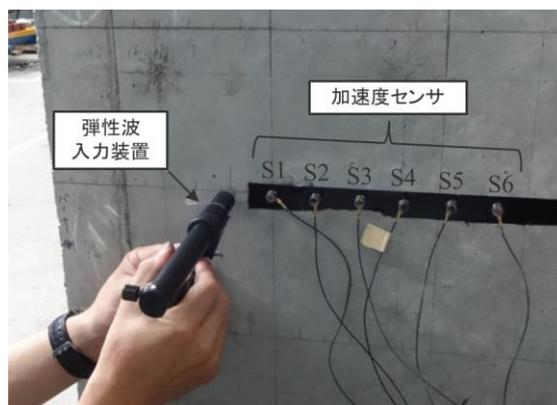
写真-1 衝撃弾性波法の測定状況
