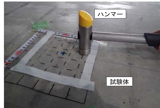
写真－3 ハンマーによる打撃状況
