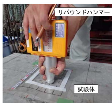
写真－2 リバウンドハンマーによる測定状況
