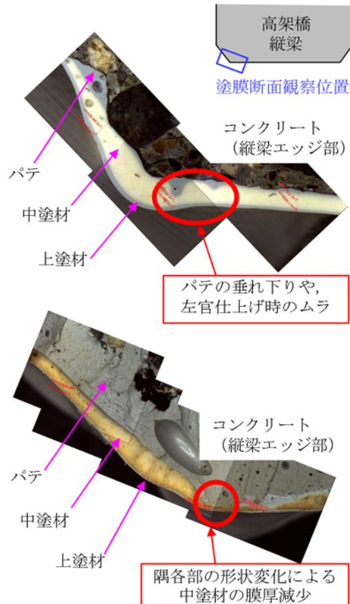
図-16 塗膜のひび割れ断面図
